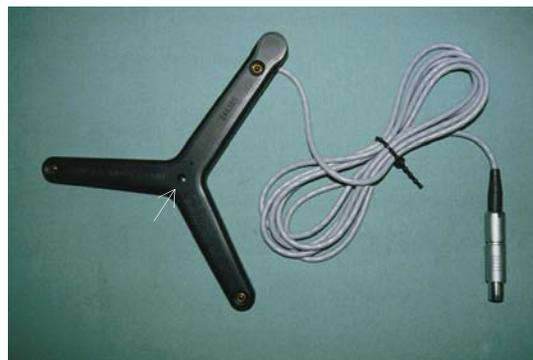
**Abb. 4** Handgriff für interaktives stereotaktisches System („Flashpoint 5000“) mit zentraler Öffnung zur Aufnahme der Biopsiestanze (weißer Pfeil) und drei Infrarot-emittierenden Leuchtdioden.
